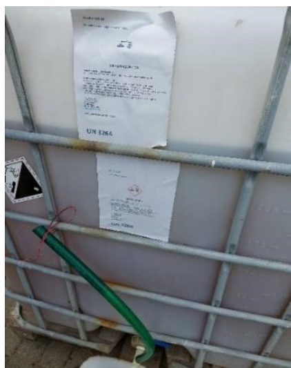
Fot. Sposób magazynowania środków chemicznych, niezabezpieczony kanister z produktem PAX 18
